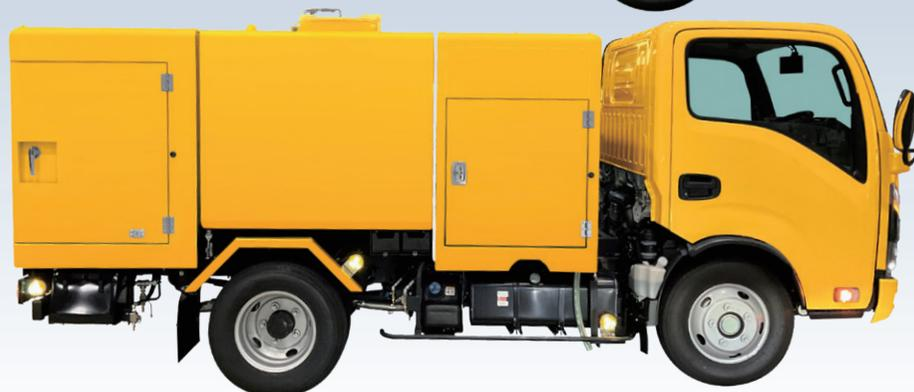
操作系統は構造がシンプルな3本レバー方式を採用。ポンプ室上部スペースに落とし込み道具箱を標準採用することで、小型シャシでも収納性は抜群です。
