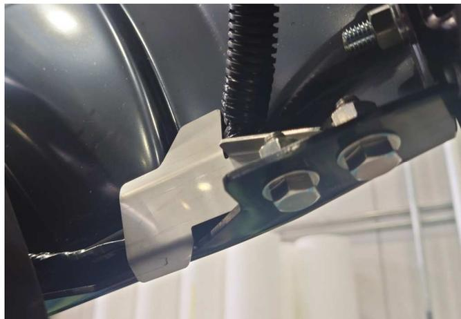
小型回転式塵芥車 幅広キャブ車において、ハイマウントリアパネル内右側配線の処置が不適切なため、後部扉を開閉する際に後部扉付属部品と接触し断線することがある。そのため、方向指示器及びその他車両後部の灯火が不点灯または点滅回数が保安基準を満たさなくなり、最悪の場合、重大事故に繋がる場合がある。
